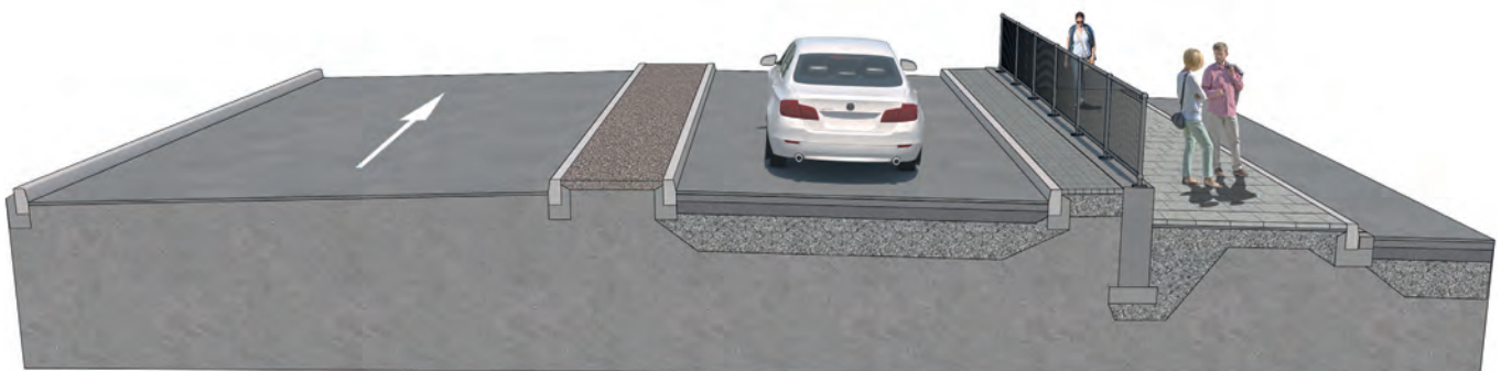
Visualisierung Fahrbahnquerschnitt mit Bypass
